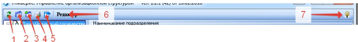
На панели управления расположены пять кнопок моментального исполнения, кнопка вызова меню редактора (6), а также просмотра «Что нового» в данном модуле (7). Первых пять кнопок имеют следующее назначение:
